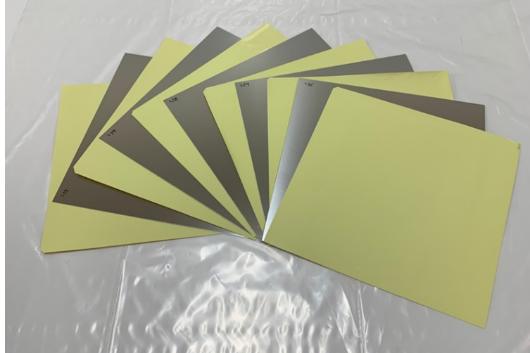
図 3.6: 原子核乾板検出器 (原子核乾板と鉄プレート). 写真中の黄色のシートが原子核乾板であり、銀色のプレートが鉄プレートである。どちらも本照射実験で使用した原子核乾板と鉄プレートと同じものである。
